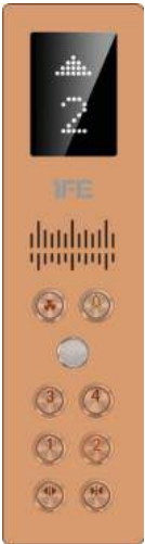
COP43 · 170×690×55 · 机械按钮 · 不锈钢面板 · 嵌入安装
