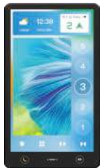
COP121 · 170×570×30 · 机械按钮 · ABS 边框 + 玻璃面板 · 嵌入式安装, 凸出轿壁 5mm
