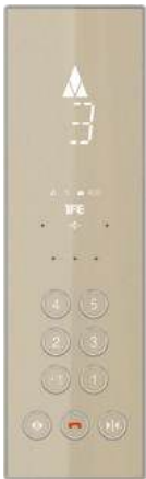
COP121 · 170×570×30 · 机械按钮 · ABS 边框 + 玻璃面板 · 嵌入式安装, 凸出轿壁 5mm
